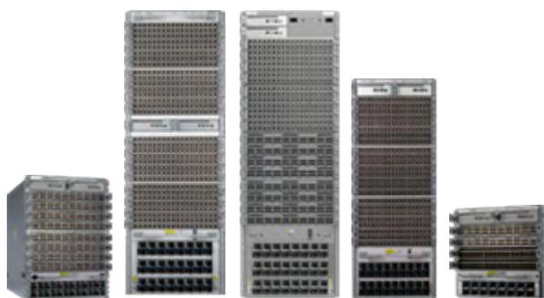
アリスタのフラッグシップ・モジュール型システムである 7800 シリーズの R4-AI 世代は、現場で実績のある完全にスケジューリングされた 100% 公平な内部アーキテクチャに加え、AI に最適化されたパケット・パイプラインを実装しており、AI に対応する最大 460 Tbps の 800G 接続をサポートします。7800R4-AI は、最大 576 の 800G ポートまたは 1152 の 400G ポートを提供し、最大 144 ノードのクラスタに対応する最も効率的で高性能なシングルボックス・ソリューションであり、大規模な 2 階層または 3 階層トポロジに最適なスパイン・システムです。
