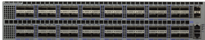
Arista 7260CX-64:64 x 40/100GbE QSFP100 端口，2 个 SFP+ 端口
