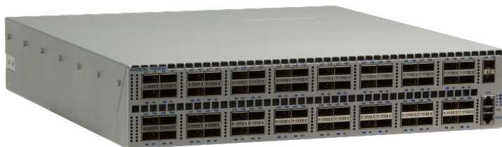
Arista 7260QX-64: 64 个 40GbE QSFP+ 端口，2 个 SFP+ 端口
