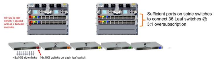
図6: スケールアウト設計におけるスパインの最初の拡張: 2枚目のラインカード・モジュール
