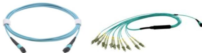
これらのポートではOM3/OM4 MMFを使用できます。サポートする距離は100m(OM3)および150m(OM4)です。MPO-12xLCのパッチケーブルは、12xLCコネクタに分岐し、SFP+への接続に対応しています。
